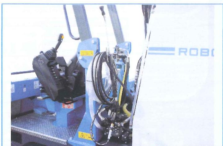
Der Hochdruckreiniger für die manuelle Reinigung (40 bar).
