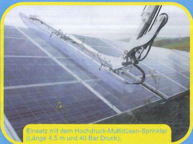
Einsatz mit dem Hochdruck-Multidüsen-Sprinkler (Länge 4,5 m und 40 Bar Druck).
