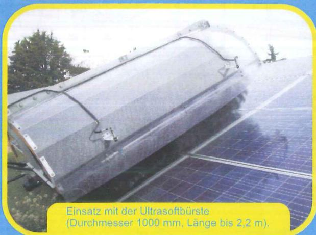
Einsatz mit der Ultrasoftbürste (Durchmesser 1000 mm, Länge bis 2,2 m).
