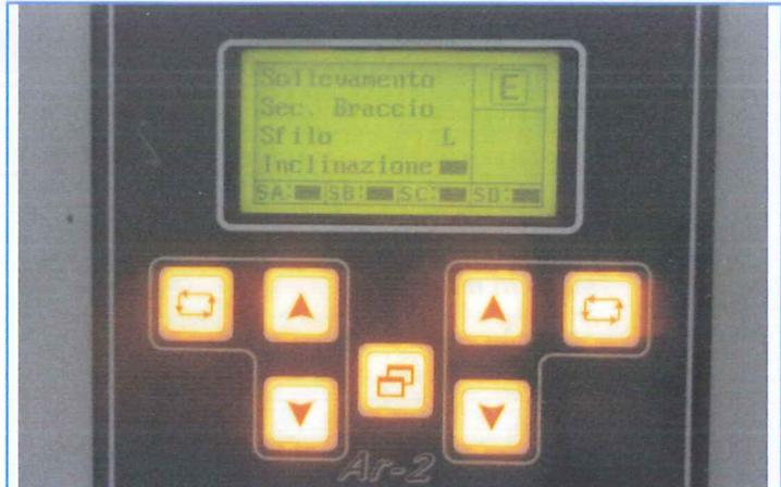
Über die automatische Steuerung werden der Abstand zur Solar-Paneele, der Winkel usw. eingestellt und überwacht.
