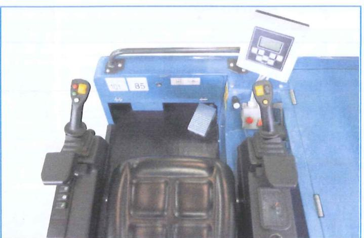
Fahrerstand mit Joy-Sticks für die Bedienung des Fahrtriebes (links) und die Bedienung des Gelenkarms (rechts), die Steuer- und Kontrolleinheit sowie das Fußpedal für Cruise Control.
